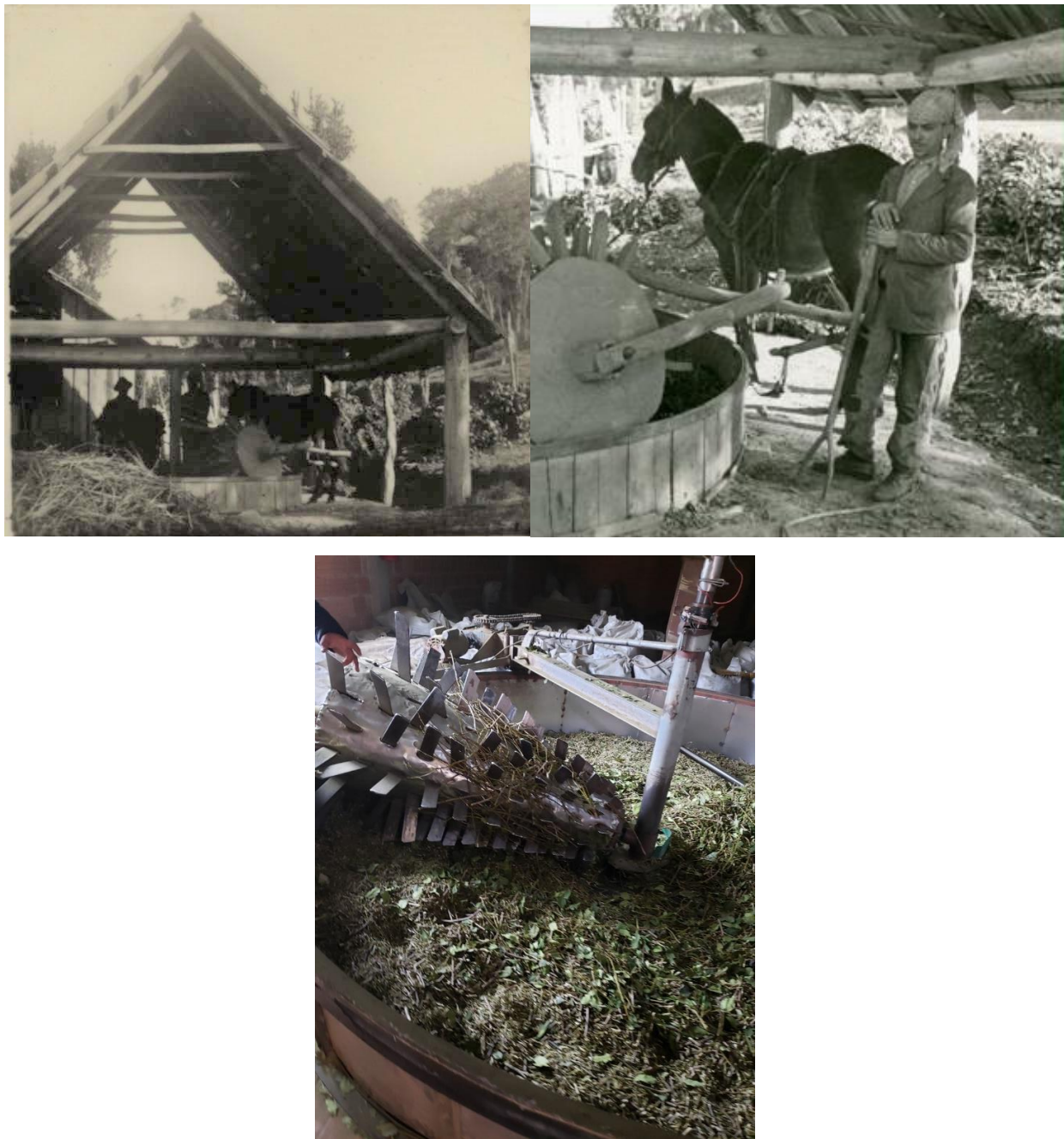
Figura 34. Barbaquás para o beneficiamento de erva-mate. Em cima: antigo barbaquá (esquerda) e cancheador feito de imbuia (direita) com tração animal. Fonte: Acervo Museu Paranaense. Em baixo: o cancheador atual revestido de metal da Ervateira Kosloski e Silva com motor elétrico. Fonte: CEDerva 2022.
