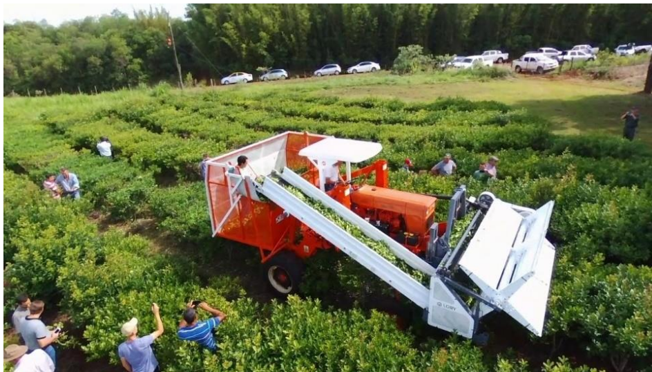
Figura 11. Protótipo de máquina de colheita de erva-mate, Argentina. Fonte: El Agrario (2021).
