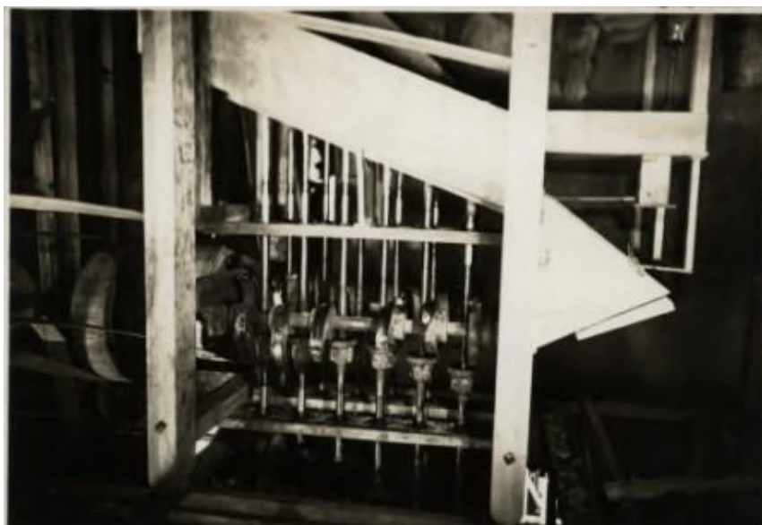
Figura 35. Soqueador ou moedor de erva-mate na Fábrica Tibagy Ildefonso, março 1933. Fonte: Coleção Francisco F. Fontana, Acervo do Museu Paranaense.
