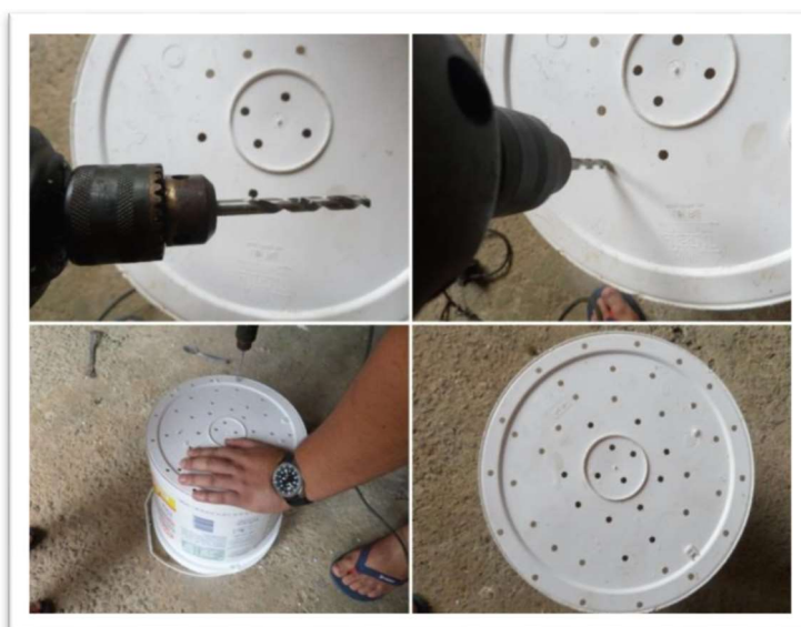
IMAGEM 4. Preparação dos recipientes, com furos na base e tampas dos recipientes 1 e 2 4 .
