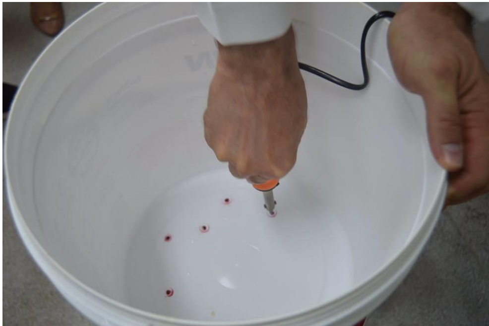
FIGURA 1 – Perfurando o fundo de dois baldes e as respectivas tampas para escoar o chorume da decomposição da matéria orgânica.
