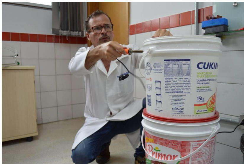
FIGURA 2 – Furos laterais nos baldes para promover circulação de ar durante a decomposição do material orgânico.
