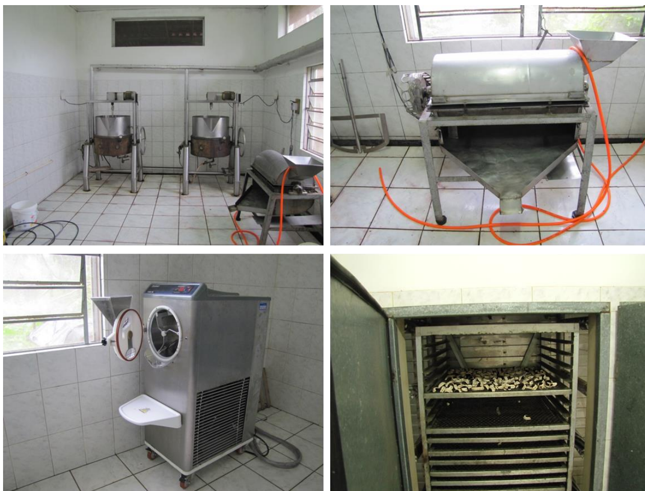
Figura 19. Equipamentos da agroindústria para processamento do açáí e da banana [Fonte: Camila Argenta].
