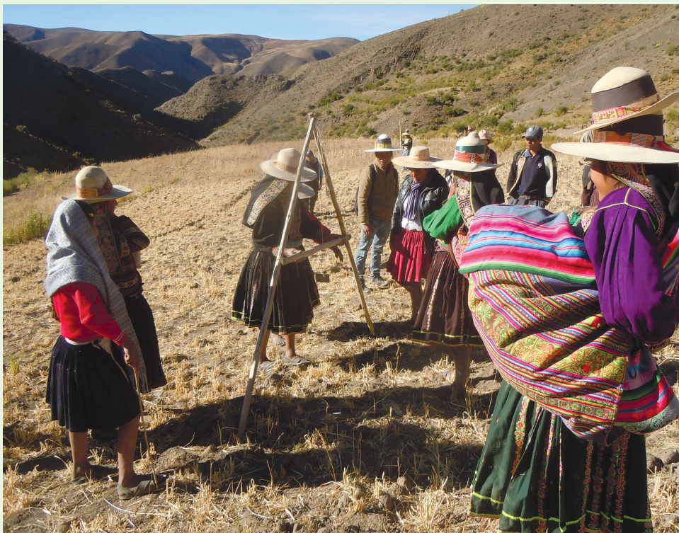
Foto 3: Trazado de curvas a nivel con nivel "A"
