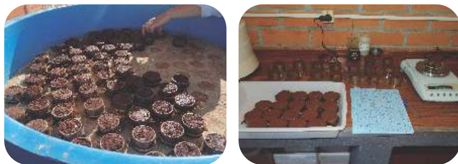
Figura 2. Coleta de amostras de solo indeformada e determinações de propriedades físicas do solo na mesa de tensão e pesagens.
